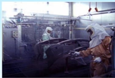
Primer Paint Spray
